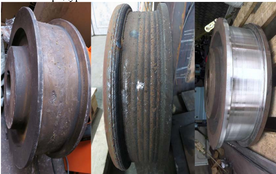
Рис. 6 Наплавка кранового катка порошковой проволокой CORODUR 250.
