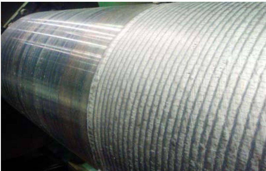
Рис. 7 Наплавка под флюсом ролика прокатного стана проволокой CORODUR 609.
